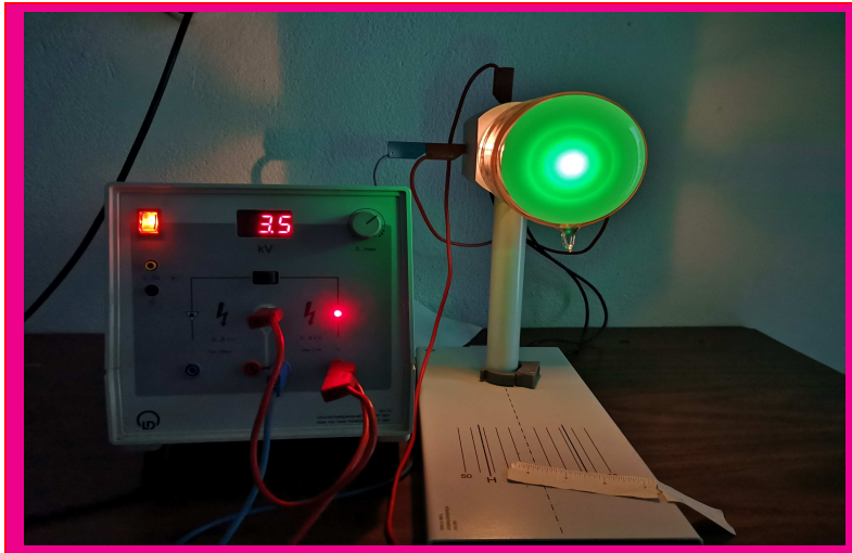
Σχήμα: Τάση Επιτάχυνσης = 3.5 kV
