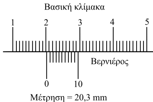
Σχήμα 4.1 Μέτρηση με την χρήση βερνιέρου (ευθύγραμμη κλίμακα).
